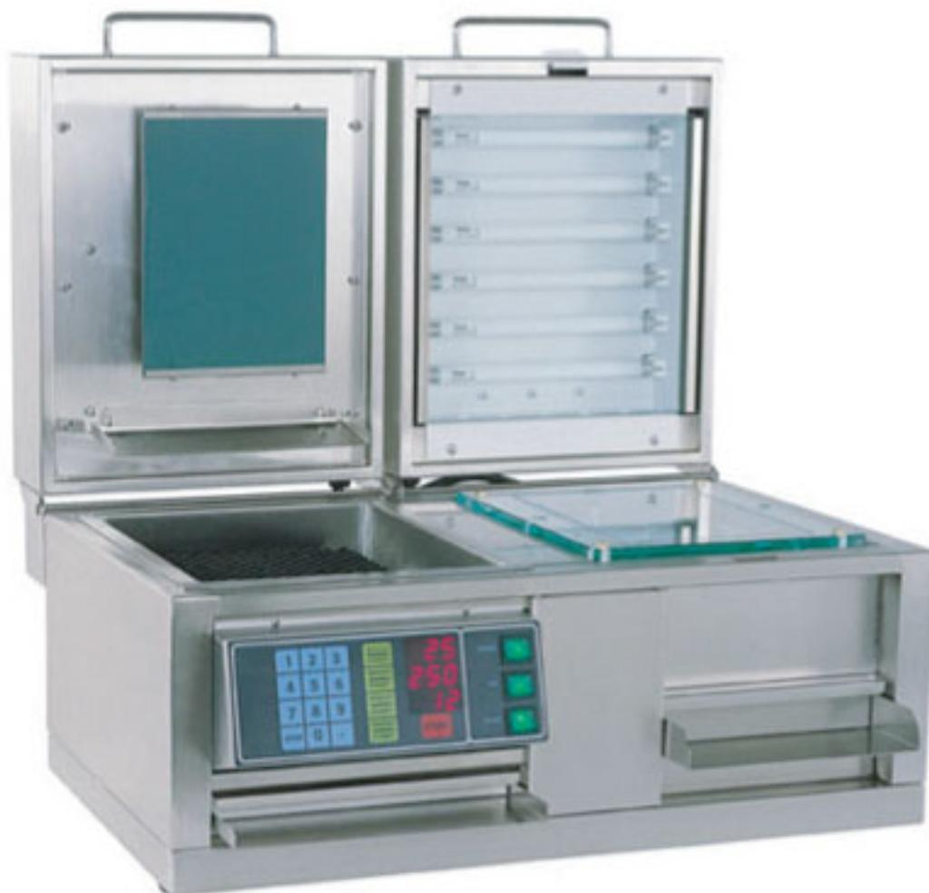
Macchina costruita interamente in ACCIAIO INOX per la Produzione di Timbri in Resina Liquida e qualsiasi tipo di clichè con sviluppo ad Acqua
